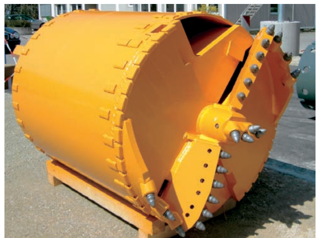
Bohreimer mit Verschleißstreifen Bucket with wear strips
